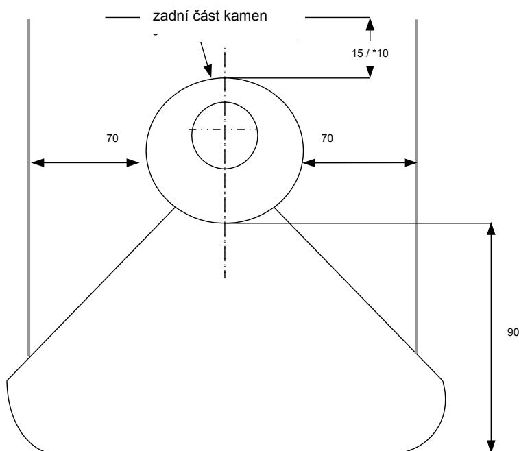
Jestliže budou kamna umístěna blízko (nebo na) hořlavých materiálů, jako je dřevěná podlaha, koberec, tak musí být umístěna na nehořlavou podložkou (nejlépe skleněnou), která by měla přesahovat min. 30cm přední část kamen a 15cm na obou bocích.
